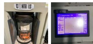
Gambar 4. Pengujian kuat tekan bata ringan CLC
