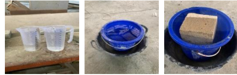
Gambar 3. Pengujian daya apung bata ringan CLC
