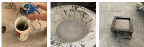
Gambar 3. Proses pembuatan bata ringan CLC
